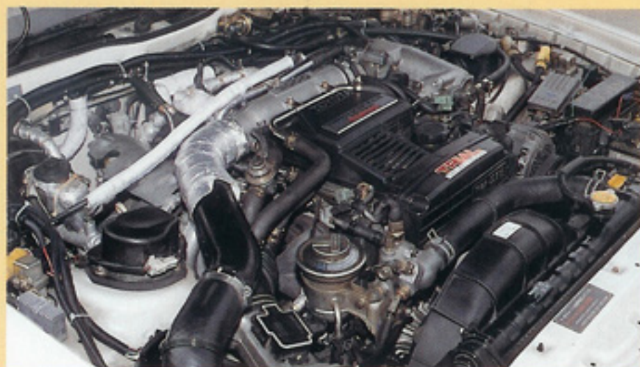
エンジン内はフルノーマル。タービンをTO-4Eに換え、サブインジェクターを追加した
