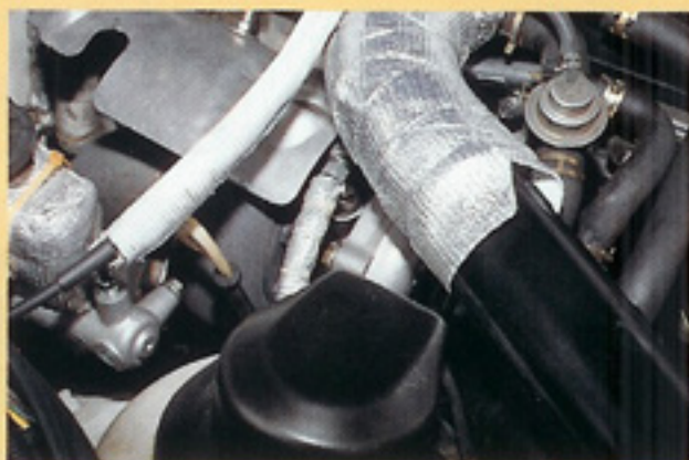
タービンをTO-4Eに換えて、マニホールドもHKS製を使用した
