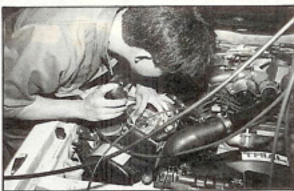
② 1G-GTの純正コンピューターは中間が濃いという燃料特性を持っている。このソアラはF-CONをドッキングしているため、その中間がさらに濃くなっている。そこでエアフローメーターを調整することで中間を絞り、かぶり現象を無くして全域に渡るスムーズな燃料配分を行つてやる。過給圧はTEST1と同じ方法で0.8kg/cm<sup>2</sup>に設定。
