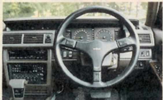
室内は、ステアリングをイタルボランテに替 えてある以外で目に見える変更点はない
