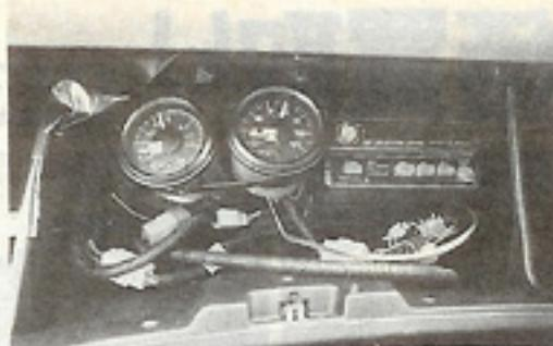
グローブボックス内にはブースト計、排気温度計、EVC、IPモニターセットされる。
