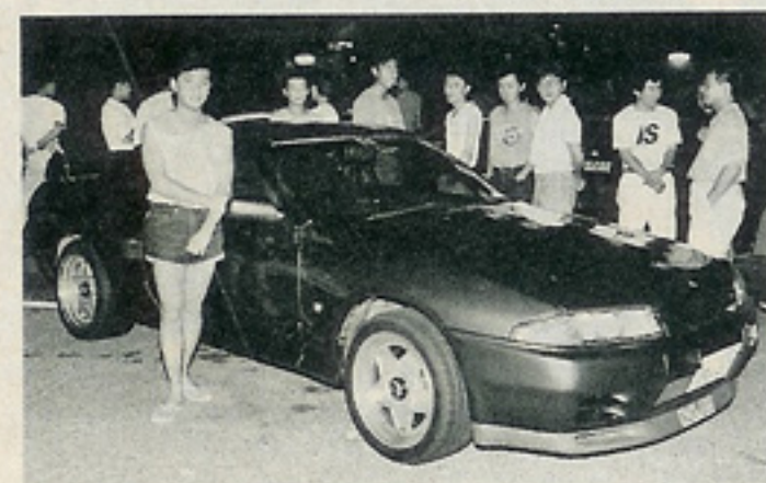
▲無敵のGT-R。タービンにT04Sに交換、ハイカムI/Cでチェーン済み
