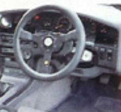
燃料系コントロールはMFCで、メーターはブースト計と排気温度計をセットしている。
