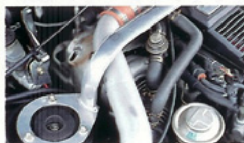
7M-GTEの備えもノーマルのエキマニにポルトオン装着だ。
