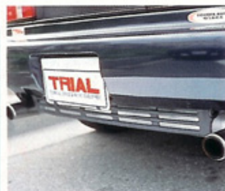
マフラーは65のHKSターボマフラー。排気効率アップは高回転での風量確保にメリット大。
