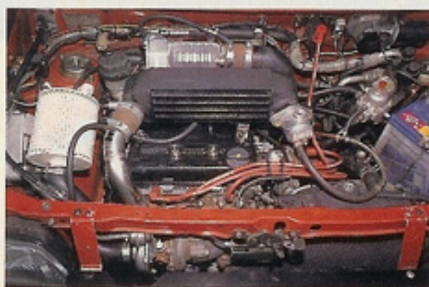
▲660Kパーツとシャレード用改タービンを使ってMAXパワーは118ps
