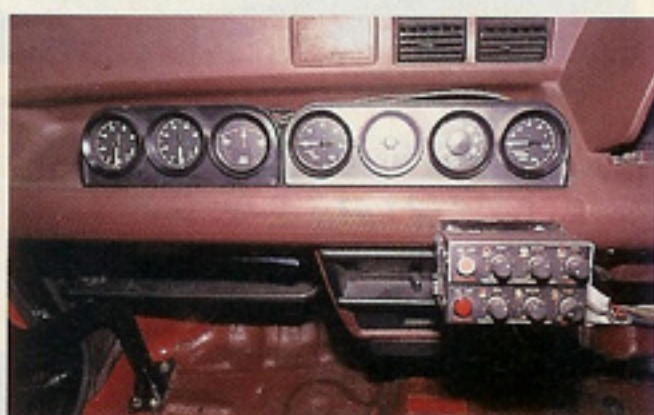
▲レーシングバージョンのため、インテリアには各計器類が並び、EFCを2基セットしている
