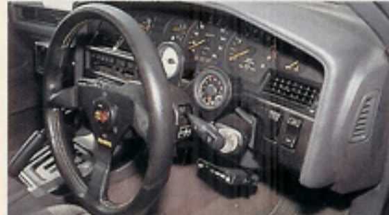
ブースト計、排気温度計は視認性のいいメーター前にセットしている
