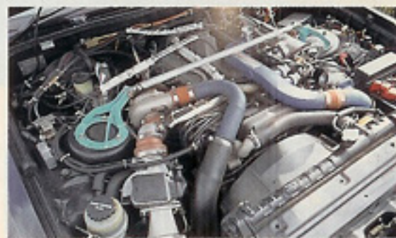
トラストステンレスEXマニ RHC6(525G) トラストスタンダードウエストゲート EVC(1.0kg/cm 2 ) 5次元80φマフラー パワーフロー F-CON レビックⅡ+380cc×2
