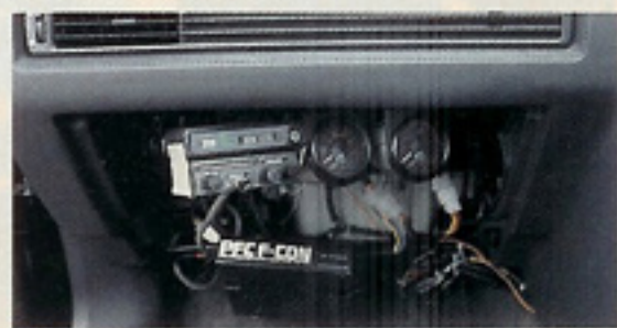
グローブボックスは取り除かれ、ブースト計、排気温度計、EVC、レビックⅡをレイアウト
