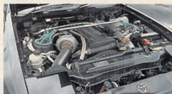
オリジナルステンレスEXマニ RHC7(724G) プリッツタイプEウエストゲート EVC(1.2kg/cm 2 ) オリジナル3層インタークーラー アルティマ80φマフラー パワーフロー レビックⅡ+380cc/min×2
