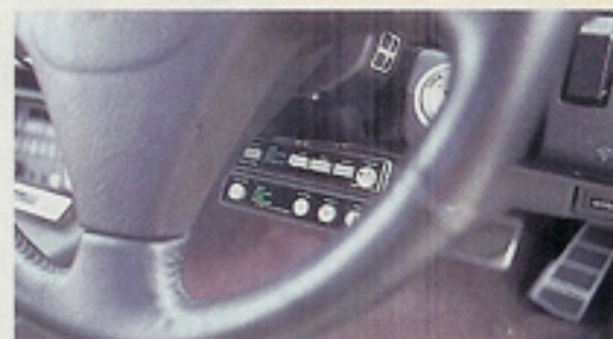
EVC、SBCのコントロール部はステアリング下にセットしている
