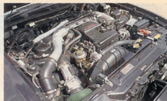
TO4E(A/R0.70) EVC(1.0kg/cm 2 ) SBC(1.2kg/cm 2 ) HKSスペシャルウエストゲート HKS75φマフラー パワーフロー M40プラグ F-CON 強化AT
