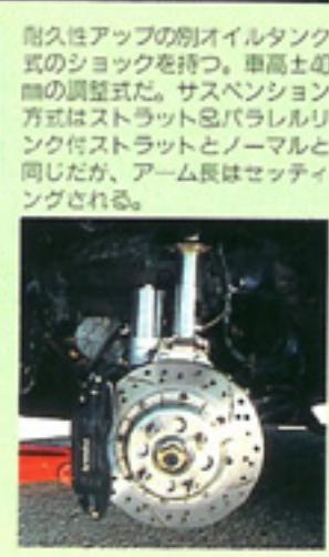
耐久性アップの別オイルタンク式のショックを持つ。車高士40mmの調整式だ。サスペンション方式はストラット&パラレルリンク式ストラットとノーマルと同じだが、アーム長はセッティングされる。
