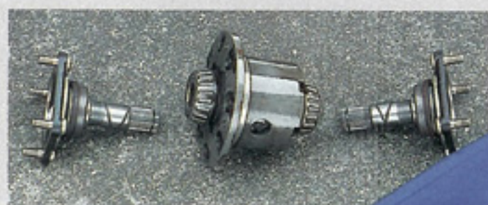
デフはクスコの機械式LSDをチョイス。インシャルトルクは12だが、今回は1段あげて効きを強めた。アンダーが出やすくなるが、そこはきっちり固めた足まわりで受けとめ、高いコーナーリングスピードを維持。コイツは欠かせないパーツだぜ。
