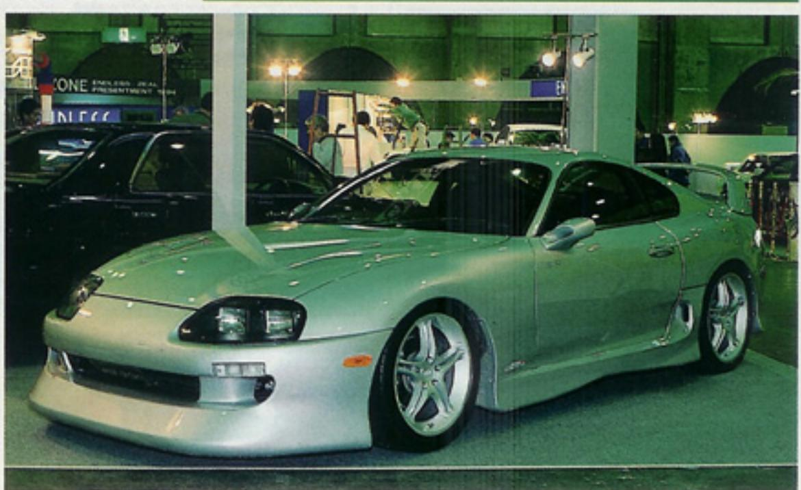
内容的には大胆な造形のエアロだが、なにかサッパリした印象のは、アクリルのカバーが付く角形4灯式に変更されたヘッドライトの効果。が、ノーマルより5cm低められ、スタイルとダウンフォースの向上を同時に果たしたリヤスポイラー、大型ながらもシンプルな面で構成されたフロントスポイラーなどサイドプロテクターも影響大で、実に大胆機能的エアロなのだ。
