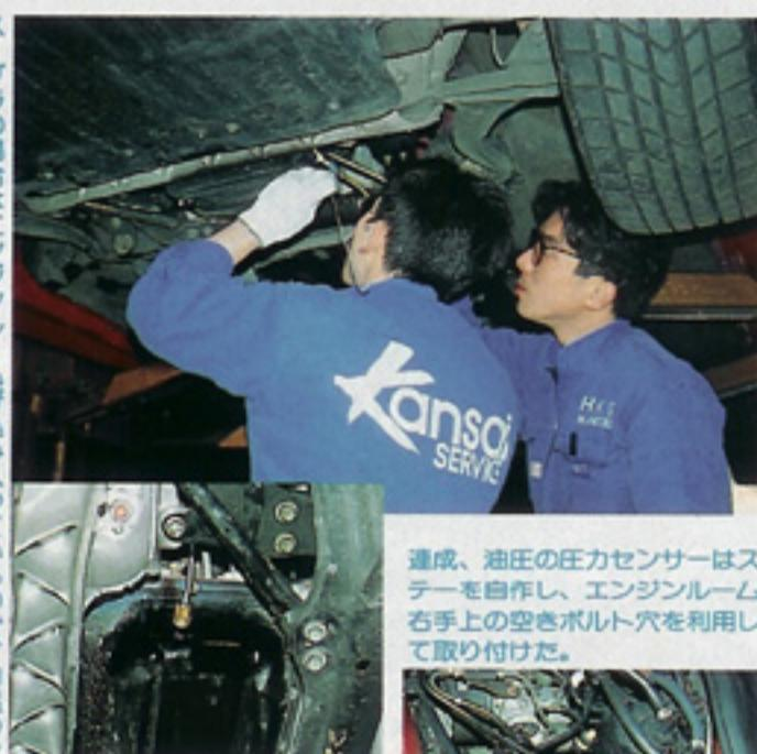
連成、油圧の圧力センサーはステーを自作し、エンジンルーム右手上の空きボルト穴を利用して取り付けた。
