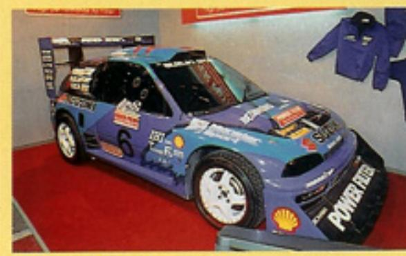
'93バイクスピードでコースレコード更新、総合2位となったマシンだ。エンジンを2基搭載し、約800psを絞り出す。中央配置シートのスバルタングクビットは圧巻。
