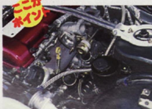
EXTRA! オートマチックのS13ターピン用コンプレッサーの大きさがT25(A/HB-08)。装着されるS14ターピンのコンプレッサーはT28(A/HB-08)。このコンプレッサー大掛かりでパワーを稼ぐのです。
