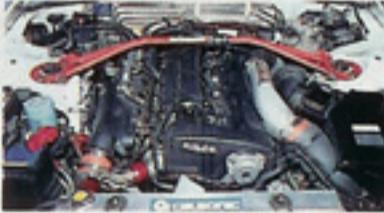
タービンはノーマルだが、オリジナルのブーストコントローラーは6000rpmを基に1.0kg/psから1.7kg/psに切り替わる。インジェクターは720cc、インターフーラーはカルソニック、オイルクーラーはHKSだ。パワーは400ps。
