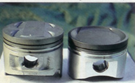
排気量アップで多く使われてきた4 AGピストン。マイナー前後で形状が違う。右はスーパーチャージャー用。
