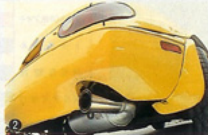
①左がGCCII右がミクスチャーコントロール。後者は-10~+10%の範囲で燃調を調整。 ②マフラーはHKSリーガルマフラーを装着。タコ足もHKSのスーパースーパーヘッダーだ。
