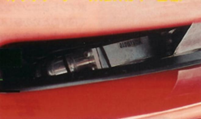
取り付けはラジエーターの前。フィッティング用のプレートは自作した。小型なので取り付け場所は選ばないが、やはり多少でも空気が当たるこの場所がいいのでは?
