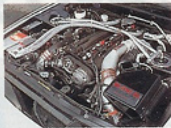
◀フルバランスオーバーホールをはじめ、各所に手が入ったエンジン。パワーは538psにまでスーパUPされている
