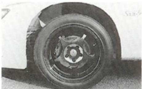
純正の4ポットキャリバーを流用するため開発されたのが“ブレーキシステムキット”だ。S14のハブまわりがほとんどそのまま使うことができたそうだが、ストラットのブレケット穴径はS13に比べてS14のほうが1mm大きい。ここは、ナックルにブッシュを圧入して合わせている。
