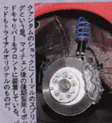
クアンタムのショックにノーマルのスプリングという足、マイチェン後の後期型用4ポッドキャリパーをフロントに装着している。パッドもトライアルオリジナルのものだ。
