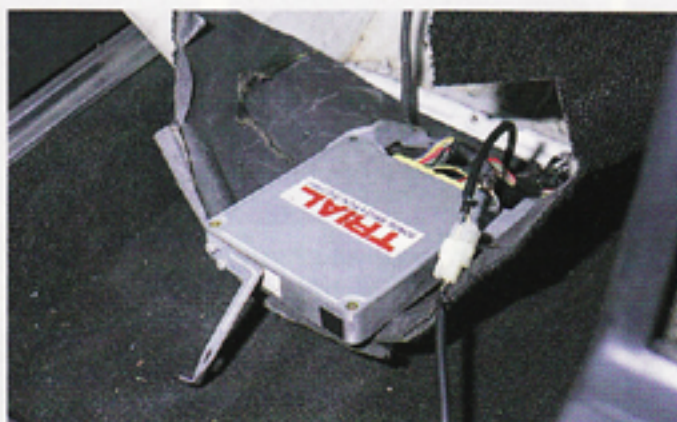
基盤から作り直した、トライアル・オリジナル・フルコンピュータ。4連スロットルのポテンシャルを引だし、ハイレスポンスと高燃費を実現。
