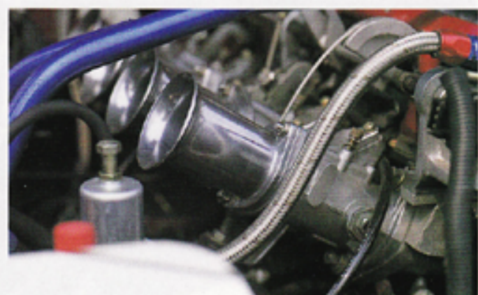
スロットル・ポジション・センサーは、GT-Rのものを流用。これにより中低速のレスポンスは、かなり向上されている。
