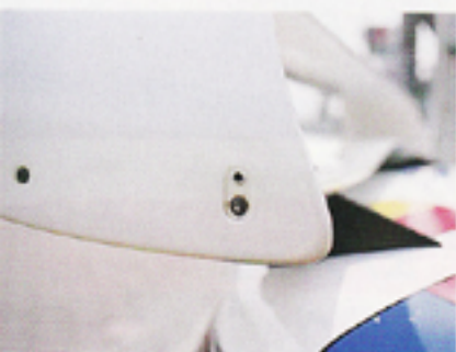
羽根の角度は2段階の可変式。下側のスポイラーは、F1風に「へ」の字になっており、整流効果?とデザイン上のアクセントになる。
