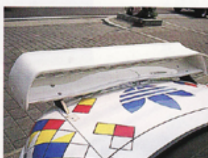
100km/hオーバーぐらいから、その効き目が現われる。トライアルのリアスポイラー。その安心感がタイムアップにつながるのだ。
