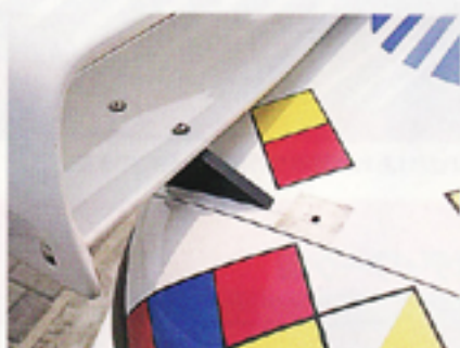
スポイラーの位置はなるべく後ろのほうが、効果大きい。タイトコーナーが多いコースでは、前側にセットして対応する。
