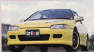
▲F、S、Rスポイラーは全てFRP製。グッとスポーティな仕上がりだ
