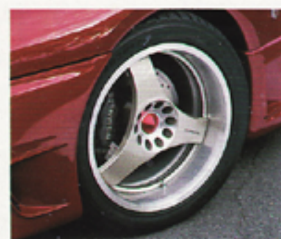
開口面積が大きく、ブレーキ冷却性能に優れるホイール。これからはホイールまで機能パーツとして考えなくては
