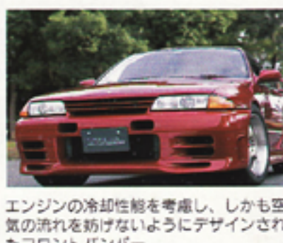
エンジンの冷却性能を考慮し、しかも空気の流れを妨げないようにデザインされたフロントバンパー
