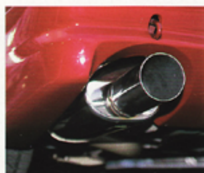
マフラーはアベックスのハイパーメガホン。公道車検対応でフロントパイプや触媒まで交換するタイプ
