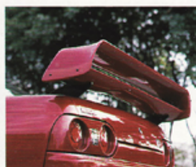
DTMマシンのような攻撃的なリヤスポイラー。市販モデルは手動ながら角度調整機構が備わる予定
