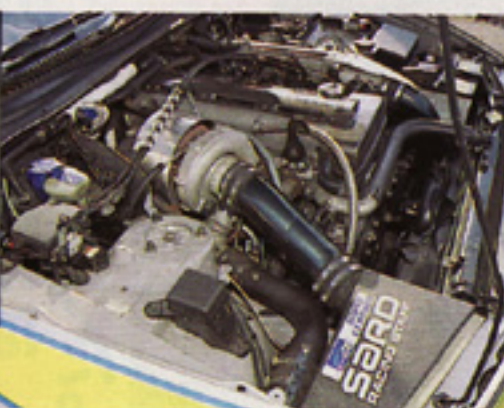
エンジンはK27 3470仕様。525 ccのメインインジェクターをメインノズルでユニットのあて調整する。
