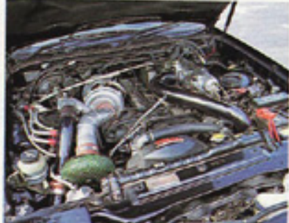
1G-GTをHKSの2Gキットで、2.48にスーパアップ。タービンはHIC7をセット。
