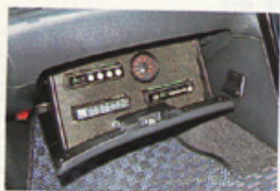
HKSのVPC、GCC II、EVC、そして車温計が、グローブボックスにキレイに収まる。でも、ホントに50歳の人のクルマなんだろう?
