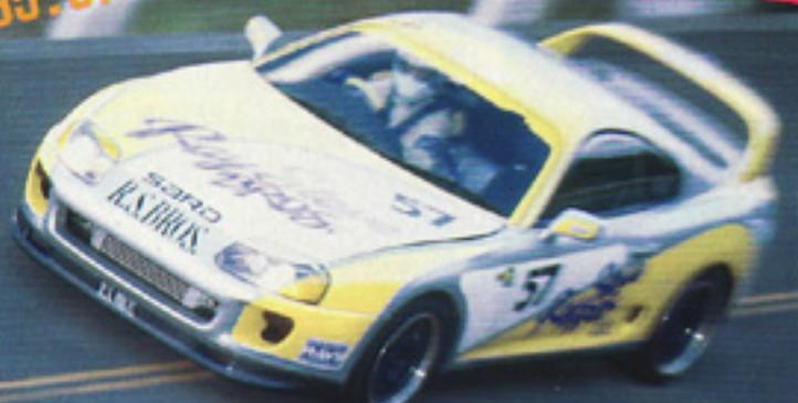
F225/45-17、R245/40-17のタイヤを履いてのチャレンジ。抵抗を減らすための幅狭小径タイヤが裏目に出て、300km/hオーバーならず。だが、ダークホースの噂どおり、2番手スピードを達成。K27MOJにフースト1.4kg/台をかけ、500dBオーバーの戦闘ポテンシャルは十分だ。
