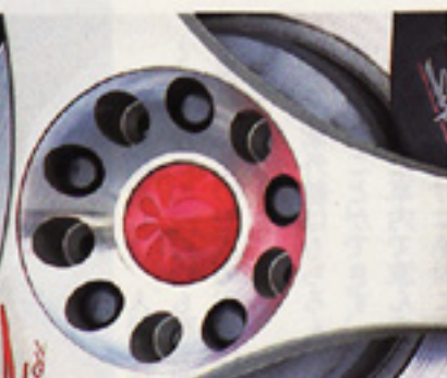
一見マルチPCD風のホールは、カッコ つけと、軽量化のためでもある。ピッチ は114.3で4穴5穴対応。(4穴は8ホ ール)
