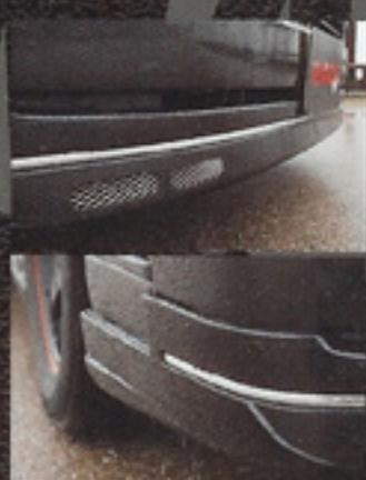
フロントグリルは純正からコンバートする本体部分と、ボンネットに張り付けるモール部分の2ピースによる構成となる。いかつくなれたフロントマスクは迫力満点!
