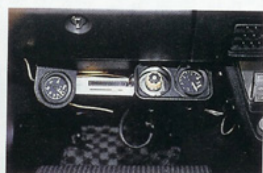
左より水温計。リタダー、ブースト・コントローラー、ブースト計が助手席に置かれる。
