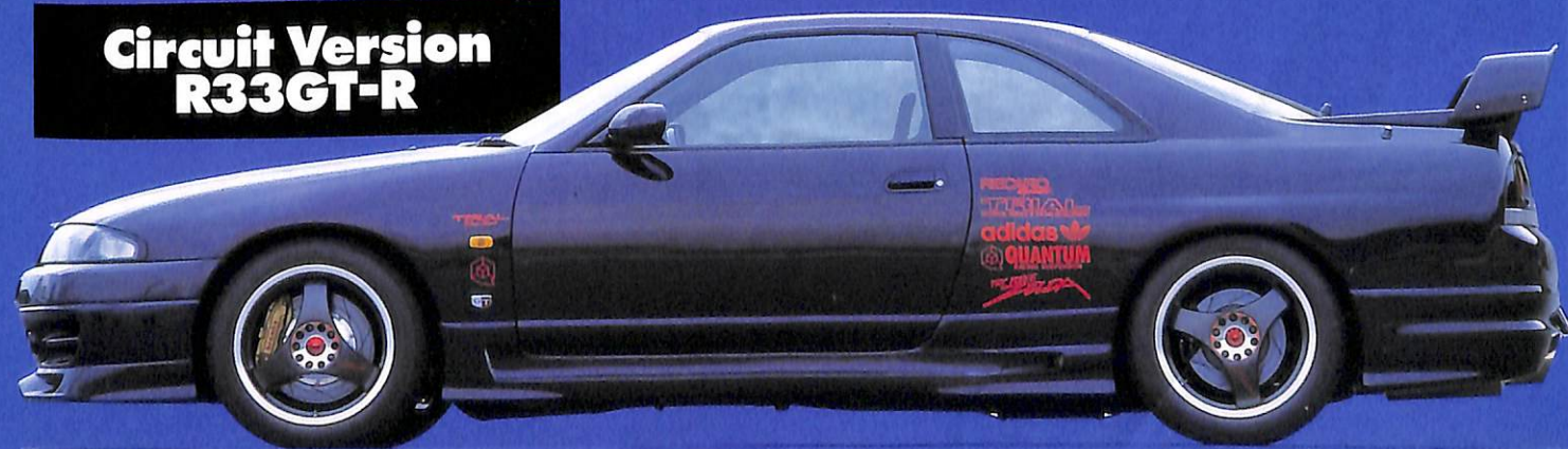
一方、特に高速コーナーでのダウンフォースが要求されるサーキット仕様のR33では、前後に大きめのスポイラーが装着される。
