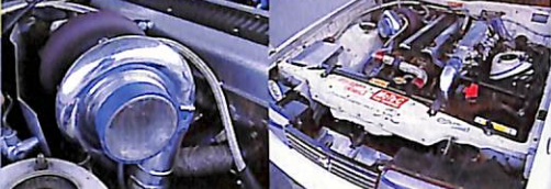
エンジンは2JZに換装。鍛造ピストンにIN、EXとも272度のカムを入れる。タービンはトラスT88-34D。メインインジェクターを860ccに換えモータックでコントロールする。
